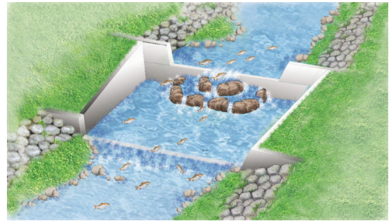
▶부채형어도, 하천중앙부 설치 낙차=90cm
